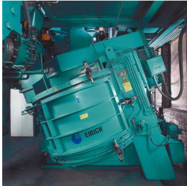
Mezcladora Evactherm® con un volumen útil de 3.000 litros.
