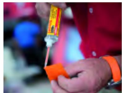
Su capacidad de relleno de holguras le permite no solo unir, sino reparar y reconstruir piezas tan diversas como ópticas y patillas de faros, soportes y anclajes de paragolpes, piezas plásticas en carrocería de automoción y en general todo tipo de substratos de difícil adhesión con pequeños desperfectos.
