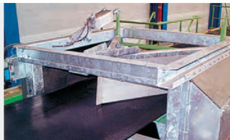
\* Rascador de descarga en V
