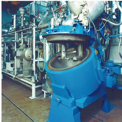
*Fig.14.2: reactor-mezclador R 08 Vac de la instalación piloto
