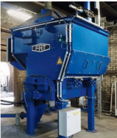
Fließbettkühler Fluid bed cooler
