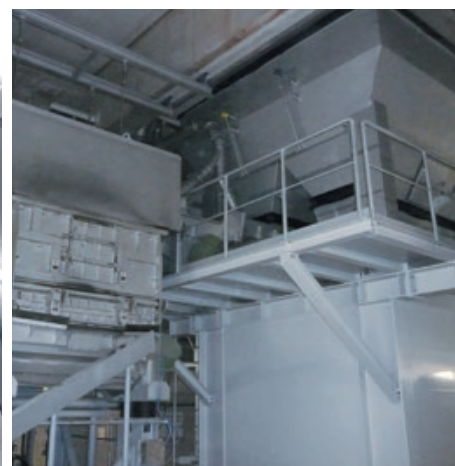
Ausleerstation mit Gegenschwingmasse Shake out station with counter vibration compound
