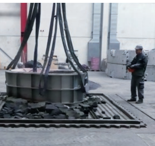
Ausschlagrost ohne Schallschutzkabine Shake out grid without noise abatement cabin
