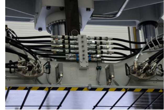
Multiacoplamiento en el portamachos en posición parking
